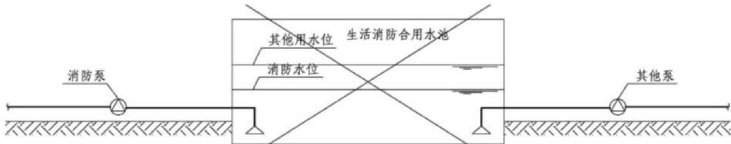
消防用水量被作他用的错误示例
